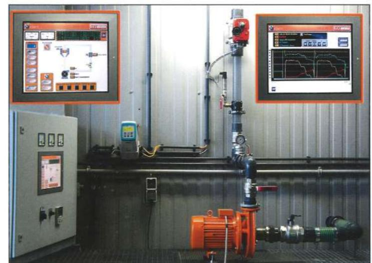
Prüfstand zur Leistungs- und Quali-
